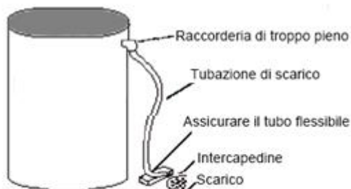
FIGURA 2. Connessione della linea di troppo-pieno.
